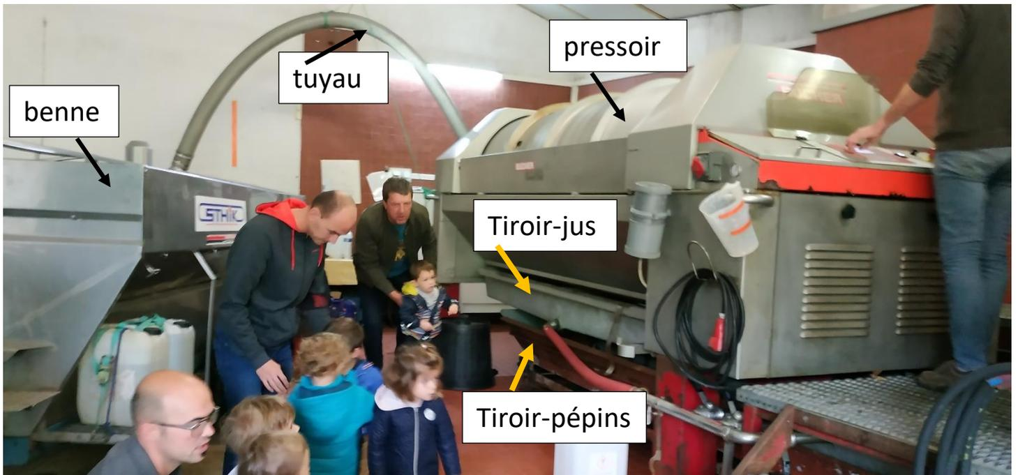
Puis Le jus est envoyé dans la cuve où il se transformera en vin ! Puis partira dans Le camion-citerne pour être mis en bouteille.
